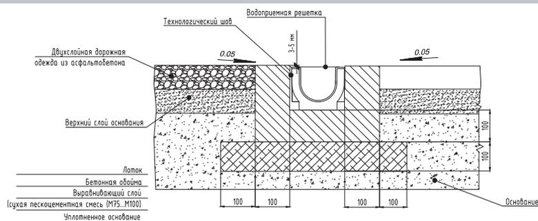
Схема монтажа водоотводного лотка **Ecotek STANDART 100.125 H 129** в поверхность из асфальтобетонного покрытия. Класс нагрузки **B 125**.
