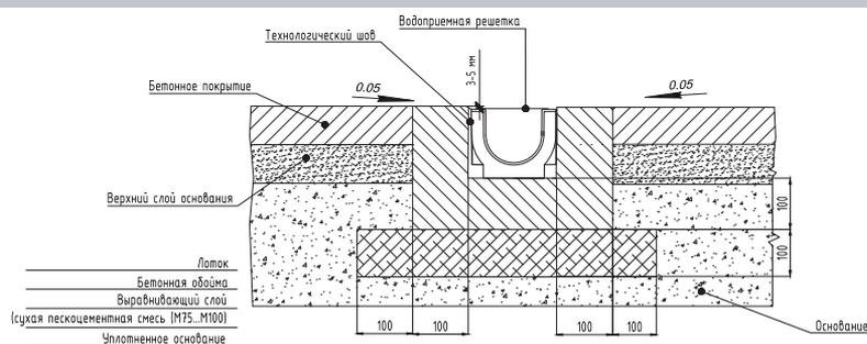
Схема монтажа водоотводного лотка **Ecotek STANDART 100.125 H 129** в поверхность из бетонного покрытия. Класс нагрузки **B 125**.
