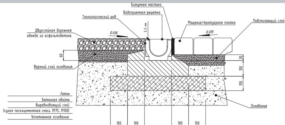
Схема монтажа водоотводного лотка **Ecotek STANDART 100.125 H 129** в поверхность, мощеную штучным камнем и асфальтобетонным покрытием. Класс нагрузки **A 15**.
