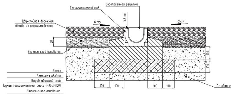
Схема монтажа водоотводного лотка **Ecotek STANDART 100.125 H 129** в поверхность из асфальтобетонного покрытия. Класс нагрузки **A 15**.
