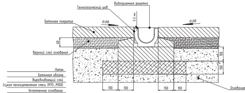
Схема монтажа водоотводного лотка **Ecotek STANDART 100.125 H 129** в поверхность из бетонного покрытия. Класс нагрузки **A 15**.
