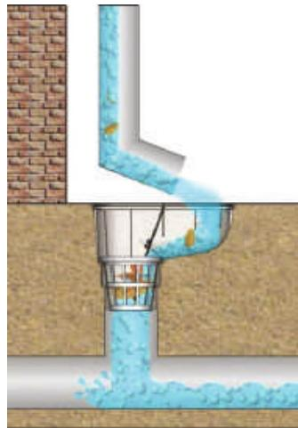
Соединение со сливной системой без прямого подключения.
